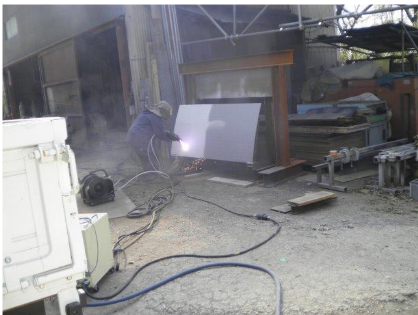
(駐車場のすべり止め—溶射仕様—アルミ溶射)
