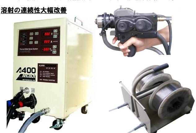
■ A40 溶射ガンは、環状スリット円錐状にエアーを噴出させ、アーク発生場所を 0.8 気圧に減圧させる「減圧内高周波アーク溶融」方式およびフリクションプル式の等速線材供給機能を持つ、軽量で操作性の良い A400 溶射用電源装置専用のアークガンです。電極を円弧状の緩やかな曲げで φ 1.6~ φ 2.4 までの線材が容易に使用可能。リーダーチップでのつまり防止にイジェクタエアー使用などワイヤートラブルが解消しています。フリクション部の 2 本のワイヤー押えテンショナーは独立に調整可能です。
