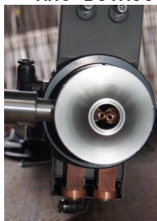
A40WFガン (ノズル正面)
